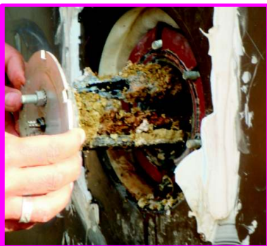
Résistance totalement confinée dans le tartre
