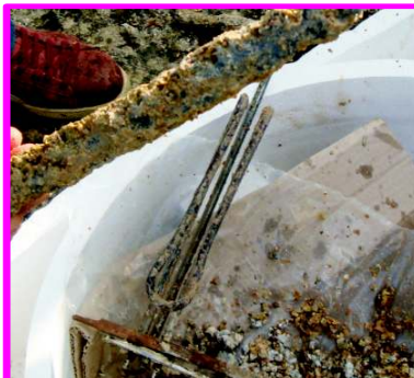
Nettoyage de résistance
